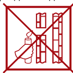
недостаточная тяга (Не используйте котел!)
